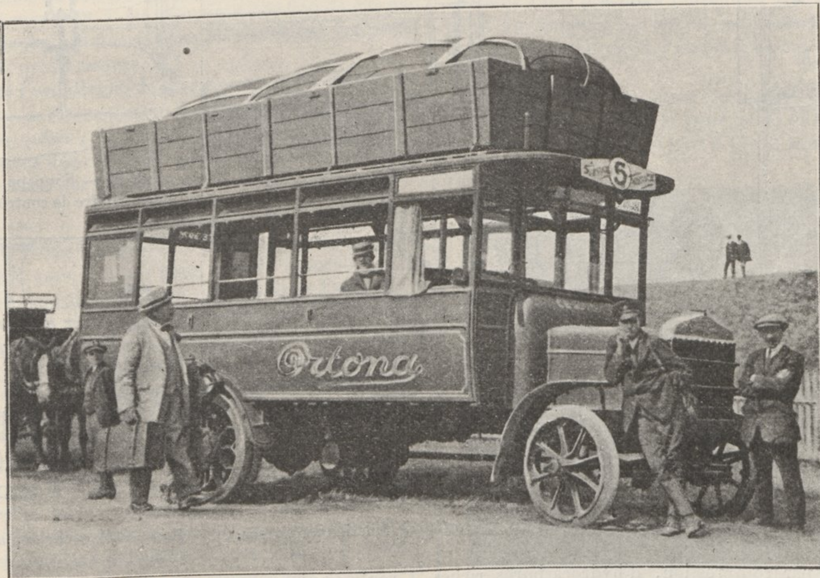
FIG. 1. — L'EMPLOI DU GAZ DANS LES AUTOMOBILES : Vue d'un autobus actionné par du gaz contenu dans un sac souple.
