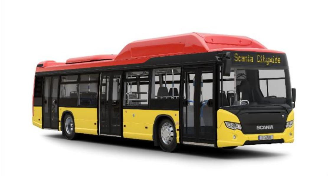
L'équipement comprend un haut-parleur extérieur et un gong piéton, des prises USB dans toute la partie passager, des feux de route et des feux de position à LED. Le moteur Scania de 9 litres développe 320 ch. Quatre réservoirs de gaz de 315 litres permettent une autonomie de 500 km, équivalente à son homologue diesel.
