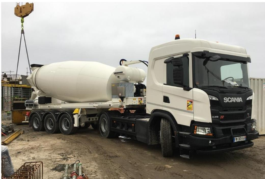
La prise de force alimentant la bétonnière est identique à celle d'un véhicule diesel, mais entraîne une génératrice qui alimente des batteries qui elles-mêmes vont faire tourner la bétonnière.
