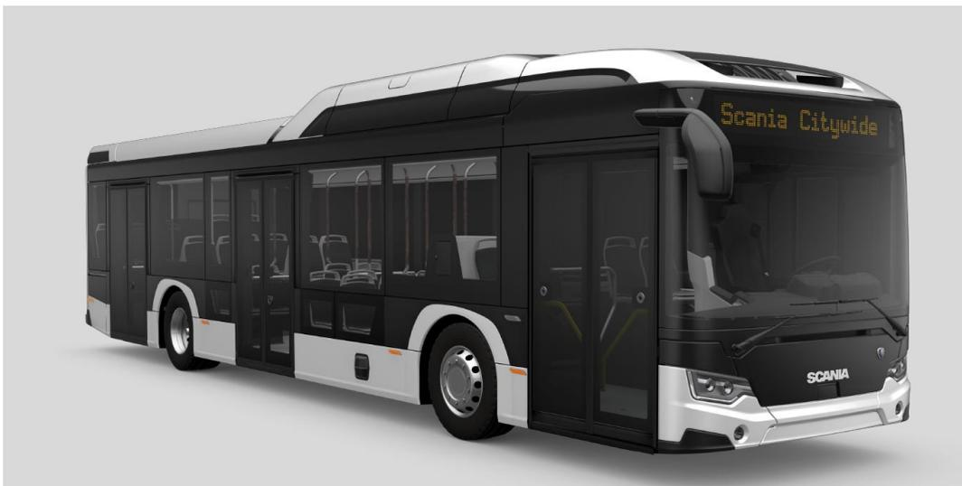
Bénéficiant d'un nouveau design et d'un poste de conduite réaménagé parfaitement fonctionnel et ergonomique, les Citywide nouvelle génération seront équipés du moteur 9 litres gaz développant 280 ch pour les 12 m et 340 ch pour les 18 m et de la boîte de vitesses automatique ZF Ecolife 2. Les portes électriques louvoyantes et la rampe d'accès électrique permettront un flux optimal des passagers ainsi que l'accès aux UFR\*.
